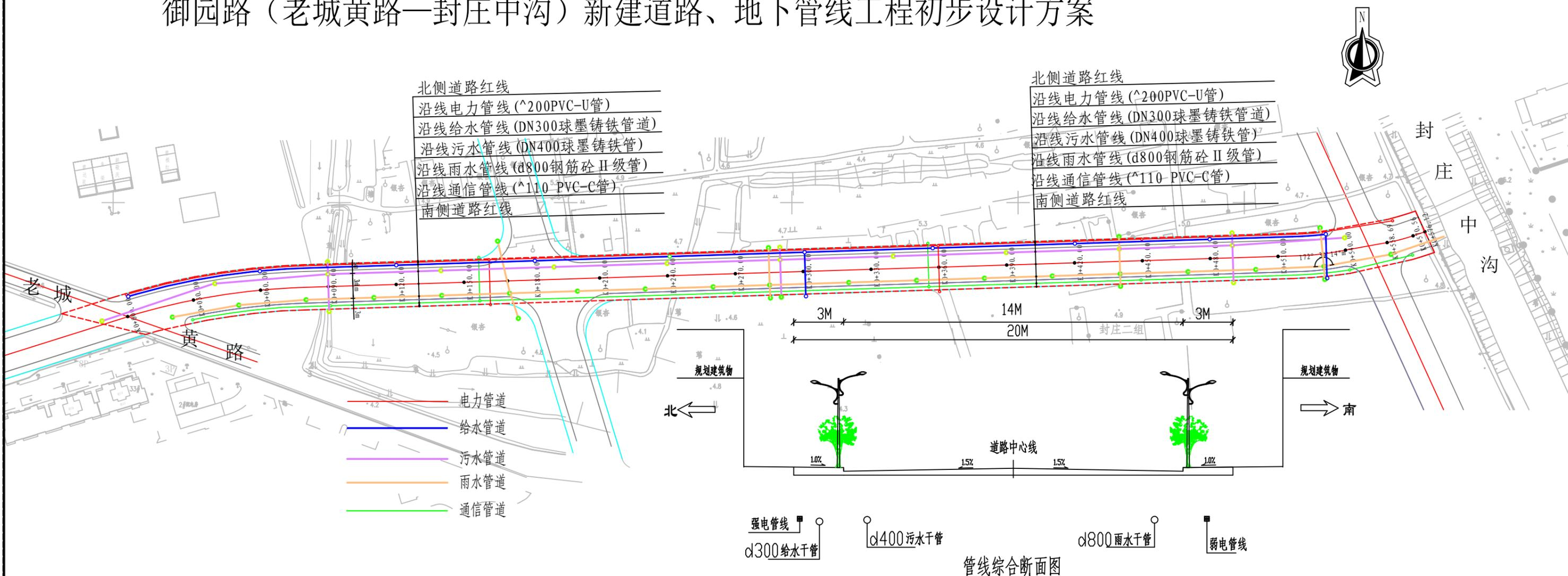
泰兴市城市投资发展集团有限公司委托设计单位编制了御园路（老城黄路—封庄中沟）新建道路、地下管线工程初步设计方案。主要内容为实施道路、电力、电信、给水、雨水、污水管网以及路灯、绿化、交安设施等配套工程。
